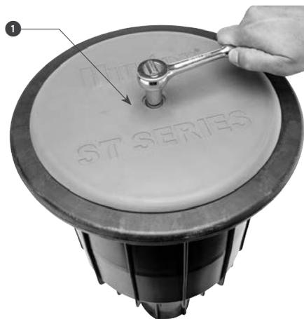
2. Utilizzare lo strumento per l'installazione/rimozione del gruppo ingranaggi per svitare la turbina dal pistone. Lo strumento farà presa intorno alle viti sotto la turbina.
