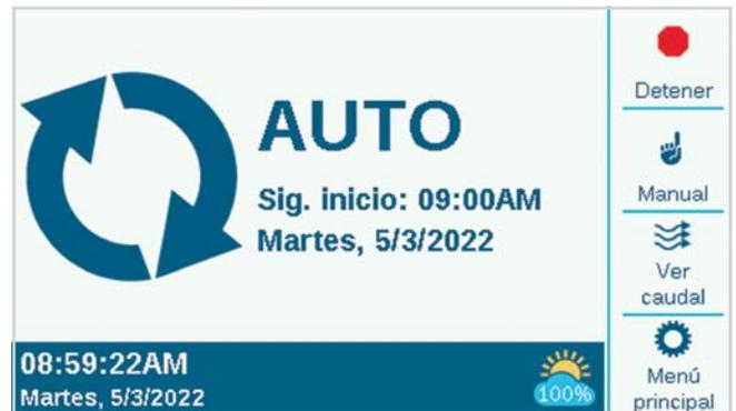
Si está instalado y habilitado un sensor Solar Sync (menú **Dispositivos**), el símbolo de Solar Sync muestra el porcentaje de ajuste actual en la parte inferior derecha del borde.
