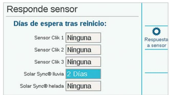
**Retardo por lluvia:** En el menú Respuesta del sensor, pulse la tecla multifunción Retardo por lluvia. Esta configuración opcional causará que el riego permanezca inactivo durante la cantidad de días fijada después de que haya finalizado la activación del sensor. Seleccione la cantidad de días en los que el riego permanecerá inactivo para cada entrada de sensor Clik.
