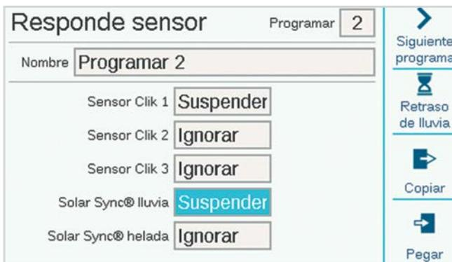
Hay tres entradas estándar de sensores Clik en el tablero de alimentación. Si se configuró un sensor Solar Sync de Hunter, también hay configuraciones para Solar Sync lluvia y helada.
