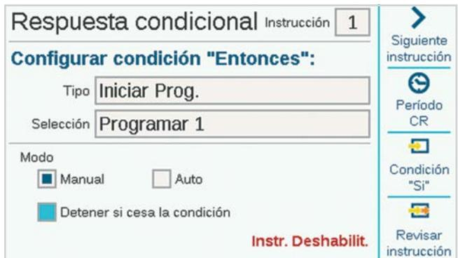
Si se marca **Detener si cesa la condición**, la estación, el bloque, o el programa solo se activará mientras exista la condición de activación. Si la condición continúa, la estación o el bloque operarán por el tiempo de riego especificado y un programa operará una vez durante toda la duración del programa.
