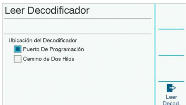
Luego pulse la tecla de función con la etiqueta Leer decodificador. Así se mostrará la configuración del decodificador en el puerto, con una pantalla para introducir los números de estación. Si la pantalla muestra "Decodificador no encontrado", los cables del decodificador podrían estar desconectados, o tal vez se conectaron los cables equivocados.
