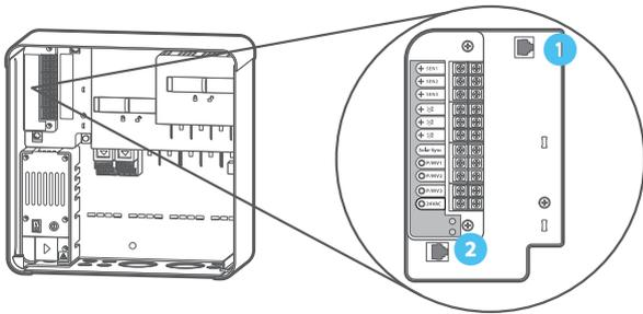
**!** No intente conectar el cable de la carátula en este puerto. El conector tiene una tapa de protección que no debe quitarse hasta que sea necesario hacer la conexión.
