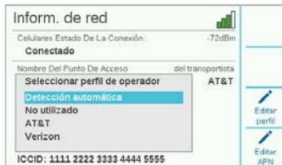
**Detección automática:** permitirá al módulo A2C-LTEM encontrar la banda correcta en la tarjeta SIM. Los usuarios internacionales siempre deben seleccionar esto primero. Si tiene éxito, el estado de la conexión mostrará «Iniciando», «Registrando» y, finalmente, «Conectado». El símbolo y el valor de la intensidad de la señal aparecerán en la parte superior derecha de la pantalla.
