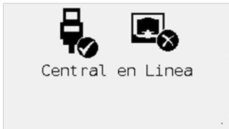
2. Se muestra la conectividad de la interfaz del campo con el ordenador central. Si están conectados tanto el cable USB como el de Ethernet al mismo tiempo, el sistema utilizará la conexión Ethernet.
