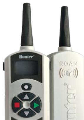
O kit de controle remoto ROAM da Hunter economiza tempo durante a instalação e manutenção de rotina do sistema. O receptor (direito) é conectado ao kit de conexão do controlador e o transmissor (esquerdo) ativa os aspersores a um alcance de 300 m. O usuário pode operar manualmente qualquer setor sem redefinir o controlador.
