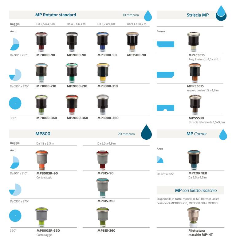
Nota: il modello MP800 ha un tasso di precipitazione di 20 mm/ora. Poiché il tasso di precipitazione differisce da quello del modello MP Rotator standard di 10 mm/ora, consigliamo di ubicare MP800 in zone separate per ottenere una precipitazione uniforme in ciascuna zona. È possibile utilizzare le strisce MP sia con gli MP Rotator serie standard sia con la serie MP800, modificando la disposizione.
