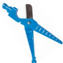
Attrezzo multifunzione per gocciolatori Hunter P/N HEMT (Pratica i fori per l'inserimento, inserisce e rimuove i gocciolatori e taglia il tubo)
