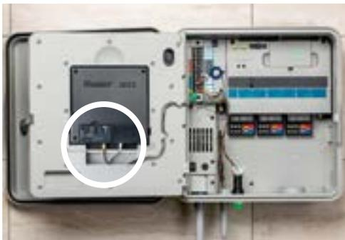
Controller ACC2 con Módulo A2C-LTE instalado
