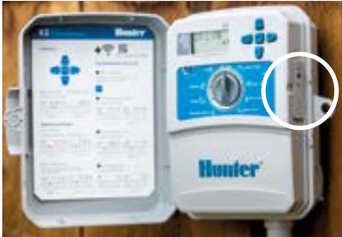
Controller X2 con módulo WAND instalado
