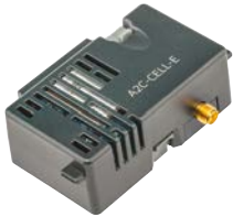
A2C-CELL-E ملحق اتصال خلوي لوحدة التحكم ACC2 بإدارة من برنامج Centralus صفحة 125
